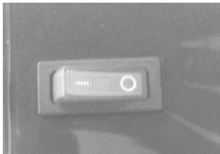
Interrupteur marche/arrêt "0" ou "1" qui permet la mise sous tension de l'appareil en position "1" ou sa mise hors tension en position "0". Toujours positionner l'interrupteur sur la position mise hors tension "0" en fin d'utilisation, ou nettoyer ou déplacer l'appareil
