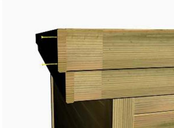
Le 3ème étage viens à l'intérieur du 2ème. Les bandeaux du 3ème étage font la même dimension que le 1er Les 4 lames du 3ème étage se superpose avec le 2ème sur 3cm. Il faut les visser (5x50mm) entre elles sur toutes la longueur avec des vis espacé tout les +/- 40cm
