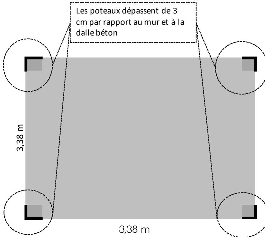
Ce schéma présente l'emprise au sol de l'abri de jardin. Ce sont donc les dimensions plancher. Sur la partie fermée, il y a 3 cm de chaque côté en plus par rapport aux dimensions affichés. Ces 3 cm correspondent aux poteaux qui dépasse de la dalle. L'objectif est que les murs arrivent à la limite de la dalle béton.
