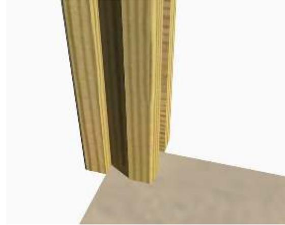
Positionnez les quatre poteaux aux extrémités de la dalle de cette façon. Veillez à ce que les poteaux restent bien de niveau au fur et à mesure que vous glissez les planches.
