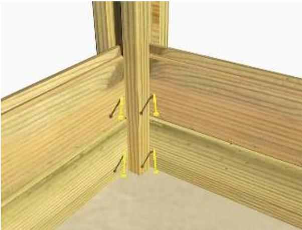
Afin de maintenir les poteaux droit, commencez à emboîter les planches dans les rainures des poteaux sur les murs qui n'ont pas d'options (Portes, Fenetre) et vissez-les (5x70mm) de cette façon.
