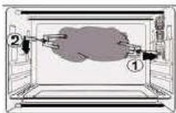
Insérez les fourches du tournebroche dans l'orifice du tournebroche, puis installez la lèchefrite sous le tournebroche
