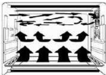
Grâce au ventilateur situé sur le côté de la cavité, l'air chaud circule dans la totalité du four, la chaleur est donc mieux répartie et la cuisson est plus uniforme.
