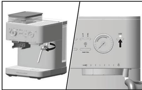
4. **Faire mousser** : Plongez l'extrémité de la buse vapeur juste en dessous de la surface du lait dans le pichet à lait. Appuyez sur le bouton Marche/Arrêt de préparation (▷|⊗) pour produire la vapeur. Faites mousser jusqu'à atteindre le niveau de mousse et la température souhaités. Pour arrêter la vapeur, appuyez de nouveau sur le bouton Marche/Arrêt de préparation (▷|⊗). Pour éviter les éclaboussures, attendez que la vapeur s'arrête avant de retirer la buse à vapeur du lait.
