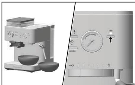
**REMARQUE** : le processus de détartrage se déroule en continu. L'eau passe d'abord par la tête de groupe, puis par le distributeur d'eau et enfin par la buse à vapeur.
