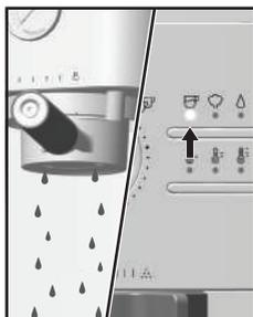
**Rincez le panier filtrant :** Nettoyez le panier filtrant pour éviter les blocages. Sans café moulu dans le panier filtrant, enclenchez le porte-filtre dans la machine et faites couler de l'eau chaude.
