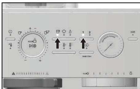
3. Tournez le bouton Température pour sélectionner la température d'extraction souhaitée. Appuyez sur le bouton Marche/Arrêt de préparation (▷|⊗) pour démarrer le cycle d'expresso sélectionné
