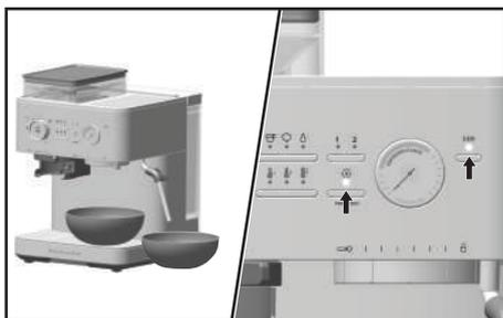
**REMARQUE** : le cycle de rinçage est analogue au cycle de nettoyage ; l'eau passe en continu par la tête de groupe, le distributeur d'eau et la buse à vapeur.
