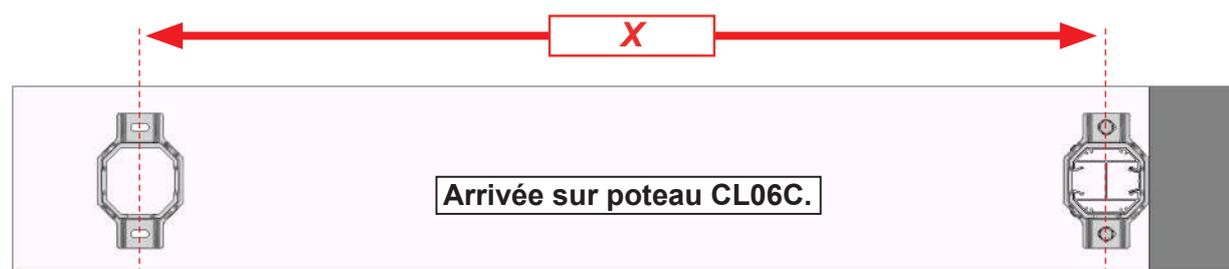
**C** Découper les lames de remplissage à la dimension **X - 20mm**.
