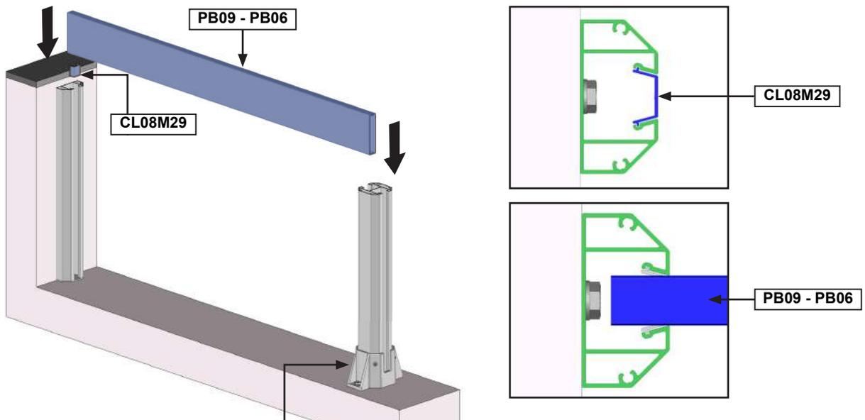
**Note :** pour les versions pleines et ajourées ne pas monter de CL08M25 en partie basse au niveau des platines.
