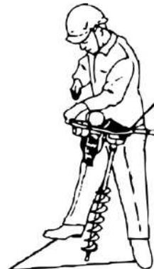
**Important! Gardez la plaque arrière de la machine près de votre corps à tout moment. La machine frappera vers l'arrière lorsque la vis sans fin se bloquera pendant le forage.**
