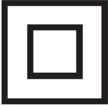
Ce symbole signifie que l'appareil possède une isolation renforcée (équivalent à deux fois l'isolation principale) sans partie métallique accessible.
