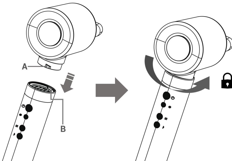
Assemblez la tête de séchage sur le corps de l'appareil en veillant à ce que les deux picots (A) de la tête de séchage soient insérés dans les deux encoches à l'intérieur de l'appareil.
