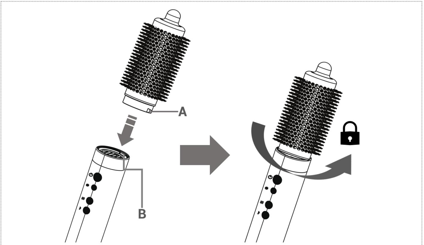
Assemblez la brosse sur le corps de l'appareil en veillant à ce que les deux picots (A) de la brosse soient insérés dans les deux encoches à l'intérieur de l'appareil.
