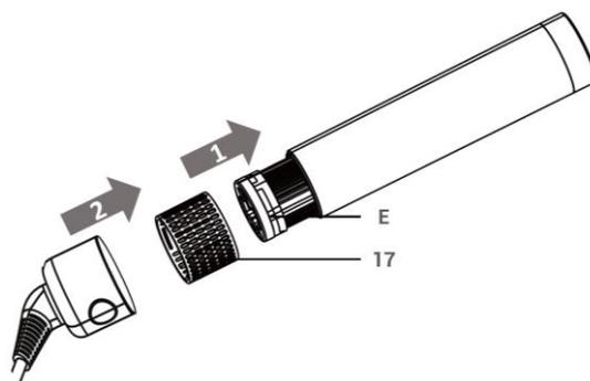
Retirez la grille d'entrée d'air pour accéder au filtre (E). Essuyez la surface du filtre avec un torchon microfibre.
