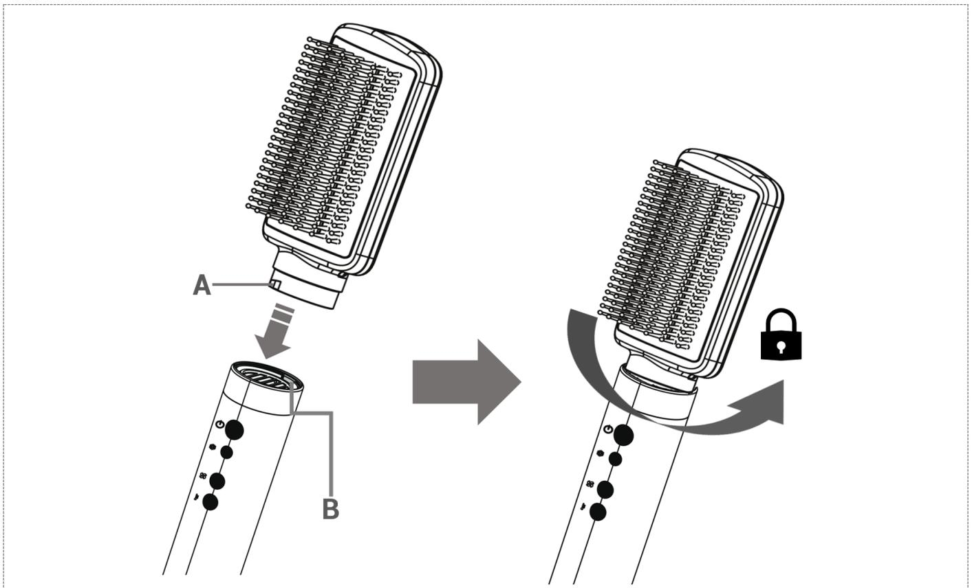
Assemblez la brosse sur le corps de l'appareil en veillant à ce que les deux picots (A) de la brosse soient insérés dans les deux encoches à l'intérieur de l'appareil.
