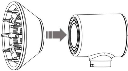
Assemblez le diffuseur en l'insérant sur la tête de séchage jusqu'à entendre un click sonore.
