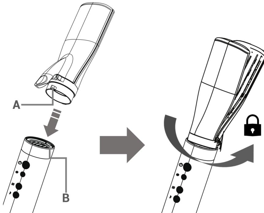
Assemblez le lisseur sur le corps de l'appareil en veillant à ce que les deux picots (A) de la brosse soient insérés dans les deux encoches à l'intérieur de l'appareil. Tournez doucement le lisseur dans le sens contraire des aiguilles d'une montre jusqu'à son point de blocage pour la verrouiller correctement au corps de l'appareil. Pour désassembler le lisseur, procédez inversement.
