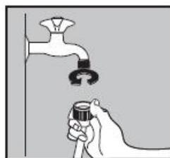
Quand il y a un robinet d'arrivée à l'arrière de la machine, il doit être raccordé à une source d'eau froide
