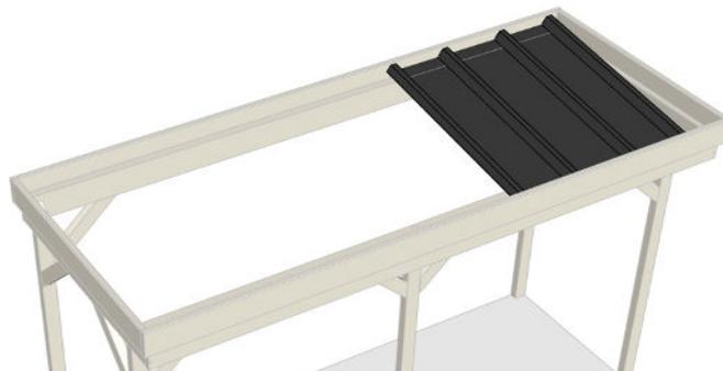
Vissez-les à l'aide des vis de tôle sous chaque panne est sur chaque ondulation de la tôle. Les vis sont auto-perforantes, vous pouvez donc visser directement dans le bac acier sans percer.
