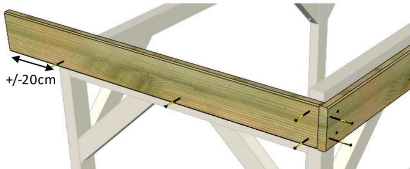
Fixez les lames du premier étage de 1,2 cm sur la gauche et la droite de votre abri. Mettez-les à fleur de la lames de face et laissez les dépasser d'environ 20 cm sur l'arrière. Vissez-les (5x70mm) dans les poteaux et dans les chevrons de côté.
