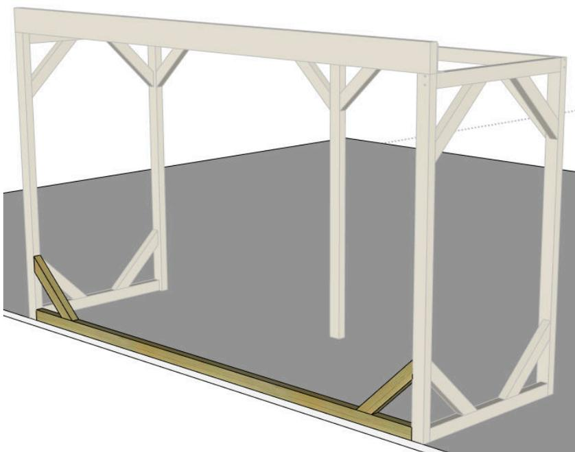
Positionnez le montant en section 45x70mm de 1,9 m vissez-les (6x100mm) à l'aide de 2 vis de chaque côté et mettez les deux jambes de forces et vissez les (5x70mm)
