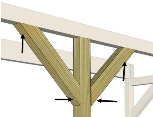
Positionnez un montant sous le milieu de la panne avant et vissez le par-dessus avec deux vis (6x100mm)
