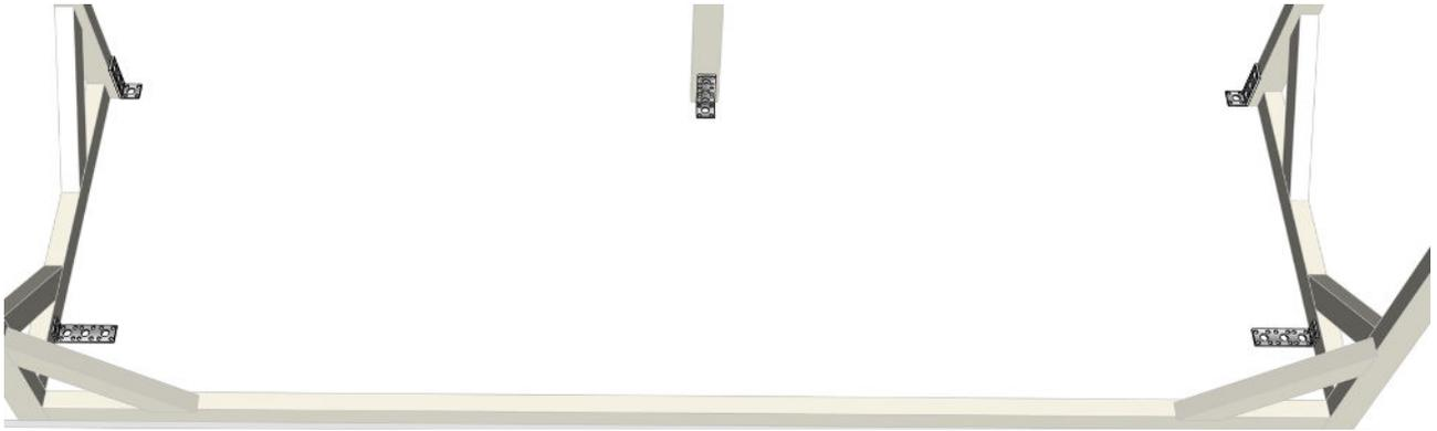
Positionnez une équerre à chaque angle de l'abri au niveau des montants, percez la dalle au niveau du gros trou de l'équerre, mettez-y une cheville et vissez l'équerre dans le béton est dans le bois (4x30mm)
