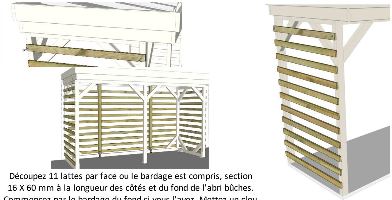
Découpez 11 lattes par face ou le bardage est compris, section 16 X 60 mm à la longueur des côtés et du fond de l'abri bûches. Commencez par le bardage du fond si vous l'avez. Mettez un clou à chaque contact avec un montant. Laissez 10cm entre chaque lattes.
