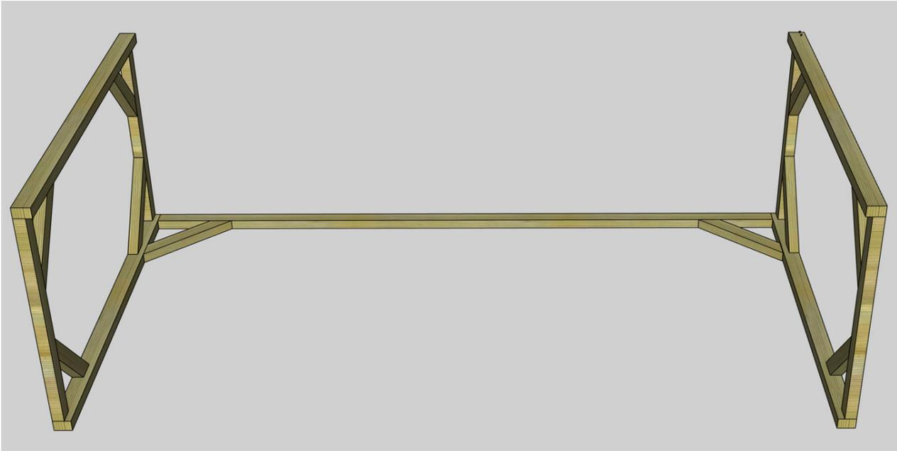
Fixez les deux portiques entre-eux à l'aide du montant en section 45x70mm de 1,9 m vissez-les (6x100mm) à l'aide de 2 vis de chaque côté et mettez les deux jambes de forces et vissez-les (5x70mm)
