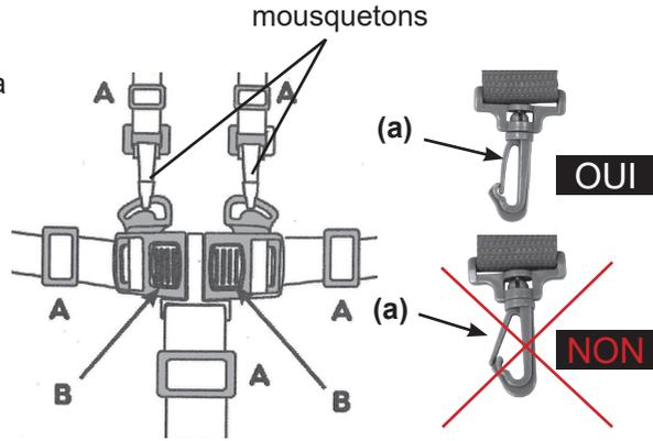
**Avant chaque utilisation, toujours vérifier que les languettes (a) des 2 mousquetons soient bien en place**
