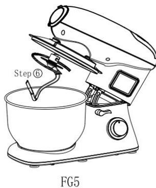
6. Appuyer sur la tête de la machine verrouille automatiquement le bouton de la tête (2), qui retourne en position horizontale (FG 6).
