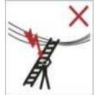
Identificeer elektrische gevaren in het werkgebied, zoals bovengrondse leidingen of andere blootgestelde elektrische apparatuur en gebruik de ladder niet waar zich elektrische gevaren voordoen.
