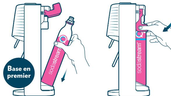
**4** Insérez la base du cylindre dans la machine
