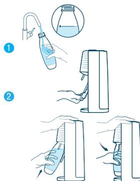
À noter : lorsqu'elle est correctement insérée, le fond de la bouteille de gazéification et la base de l'appareil sont séparés par un mince espace. Ne lancez pas un processus de gazéification si la bouteille de gazéification touche la base de l'appareil, sinon, l'eau giclera.
