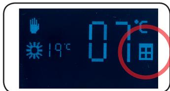
Lors de la fermeture de la fenêtre, le radiateur détectera une augmentation de la température et cette fonction sera désactivée.
