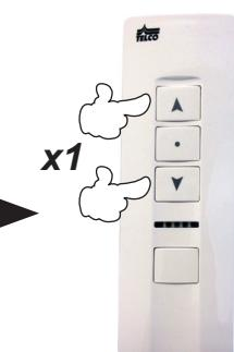
2 - Appuyer sur MONTÉE et DESCENTE simultanément.
