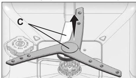
Pour enlever et nettoyer l'ensemble des bras de lavage inférieurs, tenez les points (C) indiqués sur la figure d'une main et tirez vers le haut pour l'enlever. Après le nettoyage, suivez ces étapes dans l'ordre inverse pour réinstaller l'ensemble
