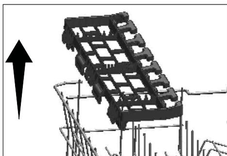
Vous pouvez facilement réinstaller la grille de service multifonction du panier supérieur sur le côté de votre panier supérieur pour l'utiliser à nouveau.
