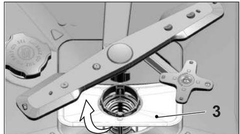
3. Pressez les deux cliquets du filtre dégrossisseur vers l'intérieur et séparez le filtre dégrossisseur de l'assemblage.
