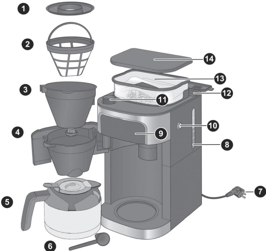
Abb. 1: Teile des Geräts
