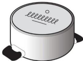
Pour vérifier que votre ustensile est adapté à l'induction, approchez un aimant. Si l'aimant ne tient pas sur l'arrière de votre casserole ou poêle alors cet ustensile n'est pas compatible avec un système à induction.
