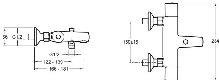
Descriptif CCTP : Mitigeur thermostatique bain-douche. E45715. Collection : SIMONE. TYPE : Mitigeur. DÉBIT (L/MN SOUS 3 BARS) : 12 L/min. ENTRAXE (MM) : 150 ± 15. MITIGEUR DE BAIN : THERMOSTATIQUE. BUTÉE DE SÉCURITÉ : 37°C. GARANTIE MÉCANISME : 5 ans. GARANTIE FINITION : 10 ans.
