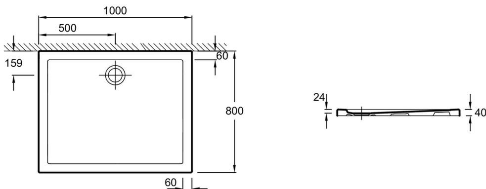
Descriptif CCTP : Receveur 100 x 80 cm - extraplat. ENF90. Collection : KYRÉO. DIMENSIONS : 100 x 80 x 4 cm. POIDS : 29,9 kg. MATÉRIAU : Céramique. TYPE D'INSTALLATION : Posé ou encastré. ANTIDÉRAPANT : Non. FORME : Rectangulaire. DIAMÈTRE DE BONDE (CM) : 9. MOTIF DE SURFACE : Lisse. NIVEAU D'ADHÉRENCE : PN6. LIVRÉ AVEC BONDE : Non.
