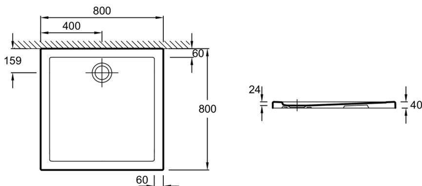
Descriptif CCTP : Receveur 80 x 80 cm - extraplat. ENB90. Collection : KYRÉO. DIMENSIONS : 80 x 80 x 4 cm. POIDS : 24,3 kg. MATÉRIAU : Céramique. TYPE D'INSTALLATION : Posé ou encastré. NORMES ET RÉGLEMENTATIONS : NF. ANTIDÉRAPANT : Non. FORME : Carré. DIAMÈTRE DE BONDE (CM) : 9. MOTIF DE SURFACE : Lisse. NIVEAU D'ADHÉRENCE : PN6. LIVRÉ AVEC BONDE : Non.
