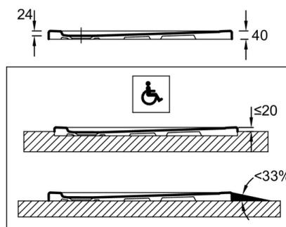
Descriptif CCTP : Receveur 90 x 90 cm - extraplat. ENC90. Collection : KYRÉO. DIMENSIONS : 90 x 90 x 4 cm. POIDS : 29 kg. MATÉRIAU : Céramique. TYPE D'INSTALLATION : Posé ou encastré. NORMES ET RÉGLEMENTATIONS : NF. ANTIDÉRAPANT : Non. FORME : Carré. DIAMÈTRE DE BONDE (CM) : 9. MOTIF DE SURFACE : Lisse. NIVEAU D'ADHÉRENCE : PN6. LIVRÉ AVEC BONDE : Non.
