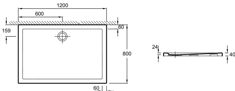
Descriptif CCTP : Receveur 120 x 80 cm - extraplat. ENG90. Collection : KYRÉO. DIMENSIONS : 120 x 80 x 4 cm. POIDS : 33 kg. MATÉRIAU : Céramique. TYPE D'INSTALLATION : Posé ou encastré. NORMES ET RÉGLEMENTATIONS : NF. ANTIDÉRAPANT : Non. FORME : Rectangulaire. DIAMÈTRE DE BONDE (CM) : 9. MOTIF DE SURFACE : Lisse. NIVEAU D'ADHÉRENCE : PN6. LIVRÉ AVEC BONDE : Non.
