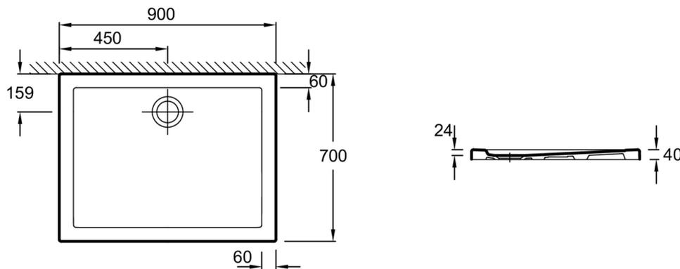
Descriptif CCTP : Receveur 90 x 70 cm - extraplat. ENE90. Collection : KYRÉO. DIMENSIONS : 90 x 70 x 4 cm. POIDS : 23,4 kg. MATÉRIAU : Céramique. TYPED'INSTALLATION : Posé ou encastré. NORMES ET RÉGLEMENTATIONS : NF. ANTIDÉRAPANT : Non. FORME : Rectangulaire. DIAMÈTRE DE BONDE (CM) : 9. MOTIF DE SURFACE : Lisse. NIVEAU D'ADHÉRENCE : PN6. LIVRÉ AVEC BONDE : Non.
