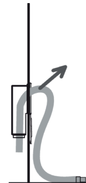
Installation de la prise à hauteur de prise de courant
