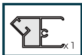
Joint magnétique h 1.90
