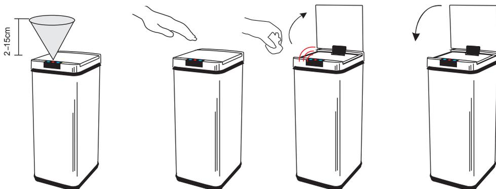
La zone du capteur est au-dessus de 2 à 15 cm au-dessus du panneau de capteurs
