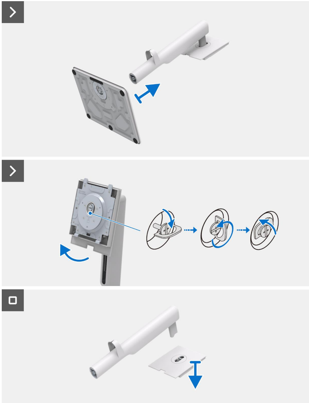
Figura 12. Desmontaje del soporte
