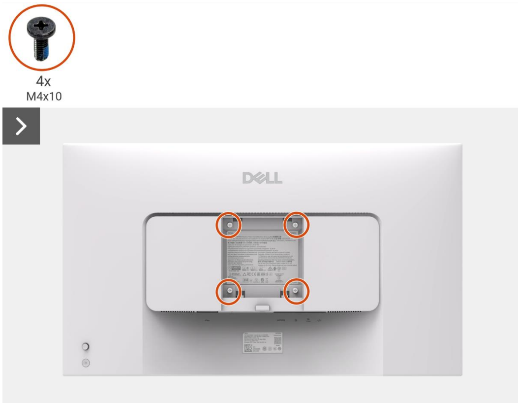
Figura 16. Desmontaje de la tapa trasera
