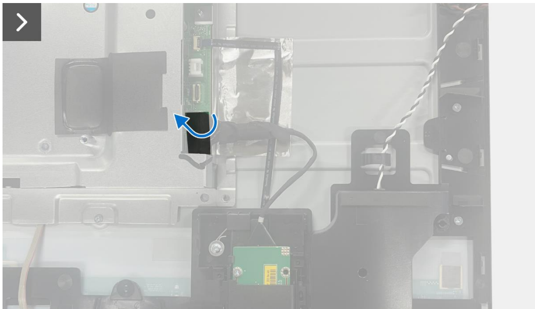
Figura 28. Desmontaje de la placa QAP
