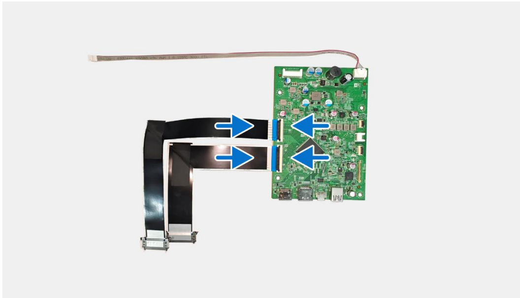
Figura 46. Instalación de la placa de interfaz
