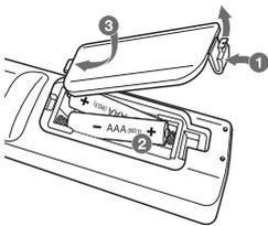
Retirez le couvercle du compartiment de la pile à l'arrière de la télécommande, puis insérez la pile en respectant la polarité **+** et **-**.
