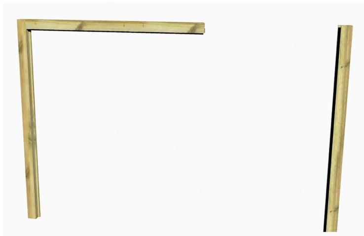
Commencez par assembler le bâti en positionnant la partie la plus courte en haut. Et les deux morceaux les plus long de chaque côté de celle-ci. Comme indiqué sur la photo ci-dessus. Vissez à l'aide de 2 vis par côté (5x100mm). Comme indiqué par les flèches.
