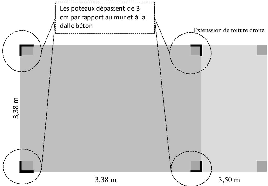
Ce schéma présente l'emprise au sol de l'abri de jardin. Ce sont donc les dimensions plancher. Sur la partie fermée, il y a 3 cm de chaque côté en plus par rapport aux dimensions affichés. Ces 3 cm correspondent aux poteaux qui dépassent de la dalle. L'objectif est que les murs arrivent à la limite de la dalle béton.
