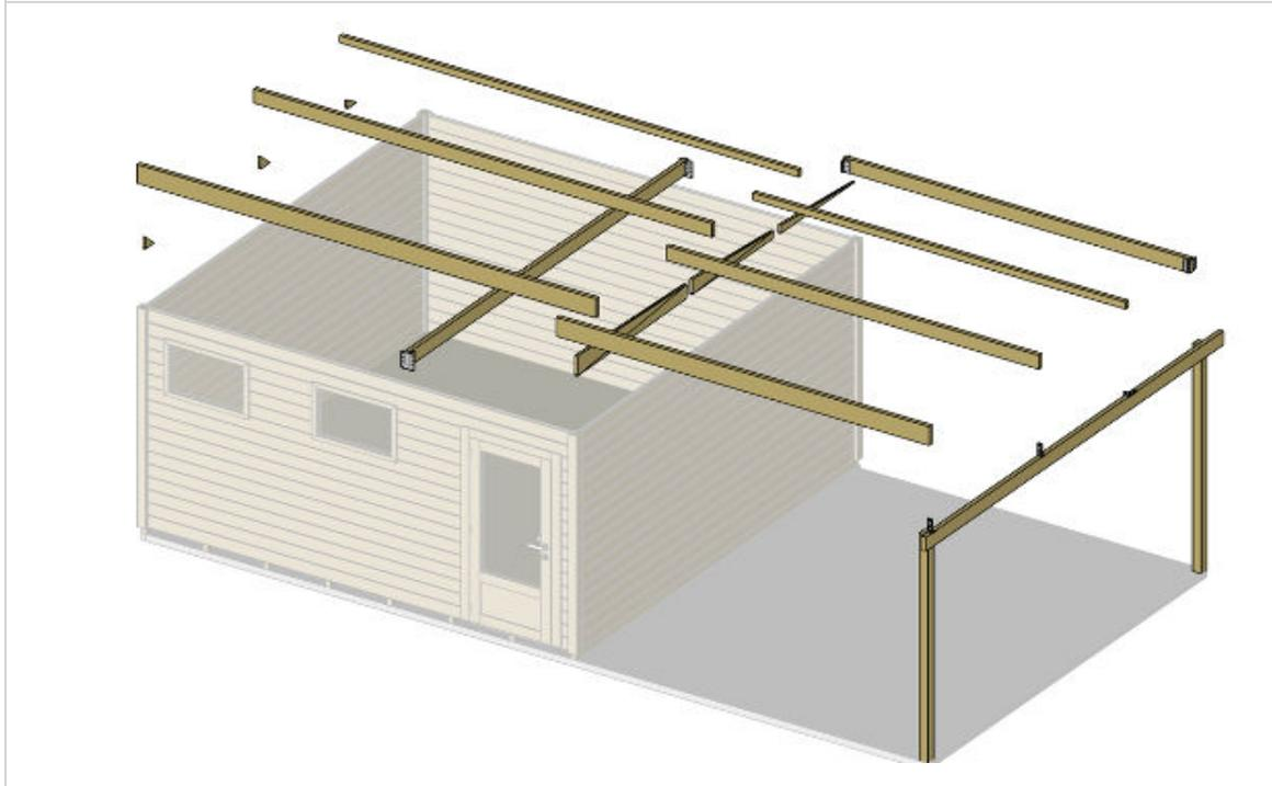
Placez les supports de pannes à 4,5 cm de la façade des poteaux sur le mur de Gauche , Pré-percez et vissez les (5x70mm) comme ceci (longues vis) :Attention, les triangles sont à mettre uniquement du côté où il n'y a pas l'extension de toiture. De l'autre côté, il faudra fabriquer des pignons par la suite.
