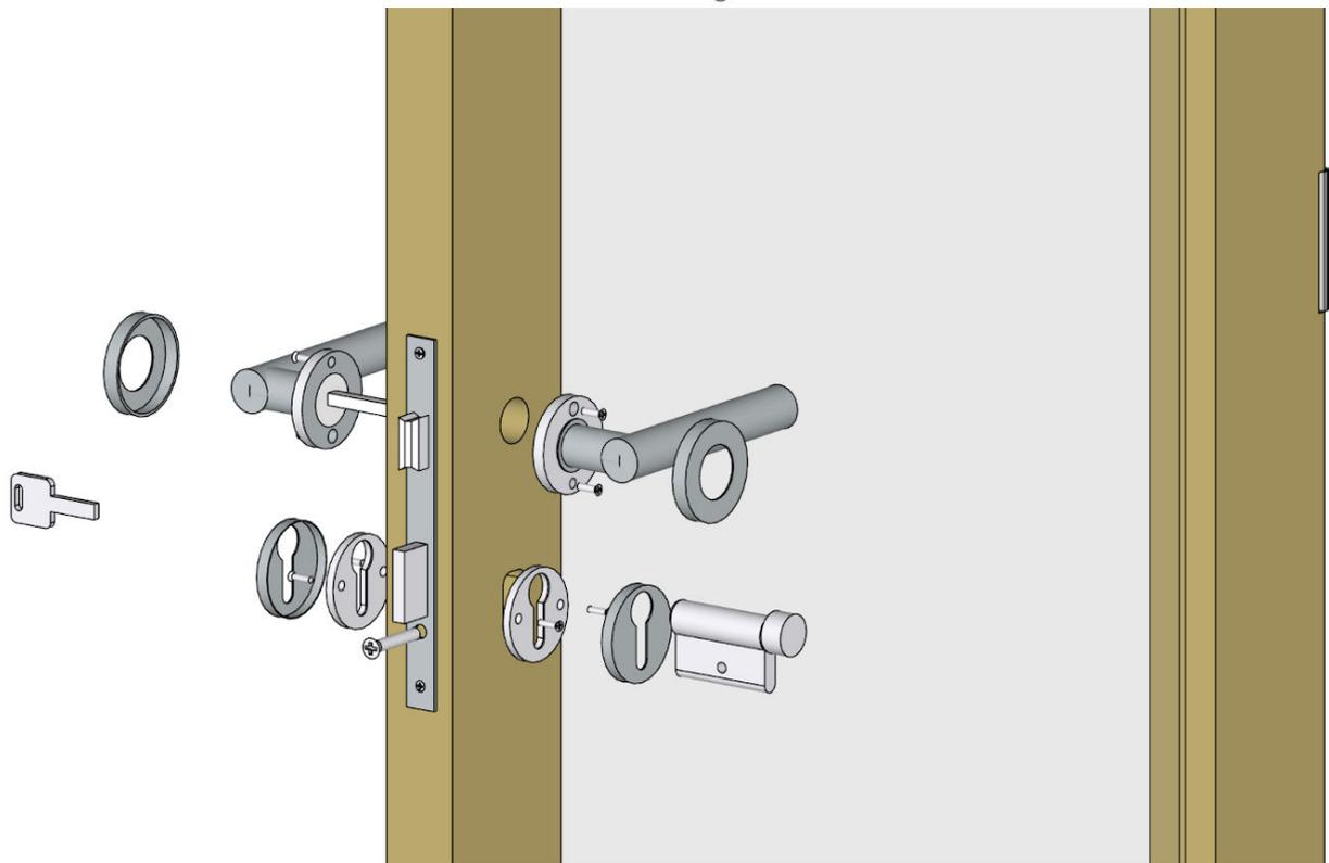
Le montage de la poignée se fait dans le même ordre que sur le schéma ci-dessus. Attention bien utiliser des vis à bois.
