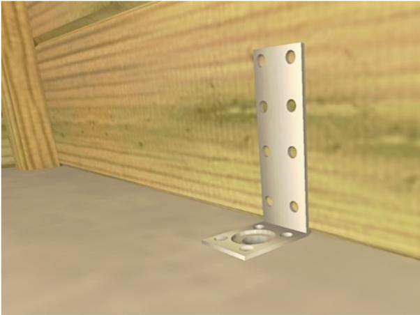
Positionnez une équerre à chaque angle du chalet au niveau du mur, vissez l'équerre dans le plancher(5X70) au niveau d'une lambourde est dans le mur (4x30mm)
