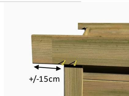
Fixez les lames du premier étage de 364,6 cm sur la gauche et la droite de votre abri. Mettez-les à fleur de la lames de face et laissez les dépasser d'environ 15cm sur l'arrière. Vissez-les (5x70mm) dans les poteaux et dans les chevrons de côté.
