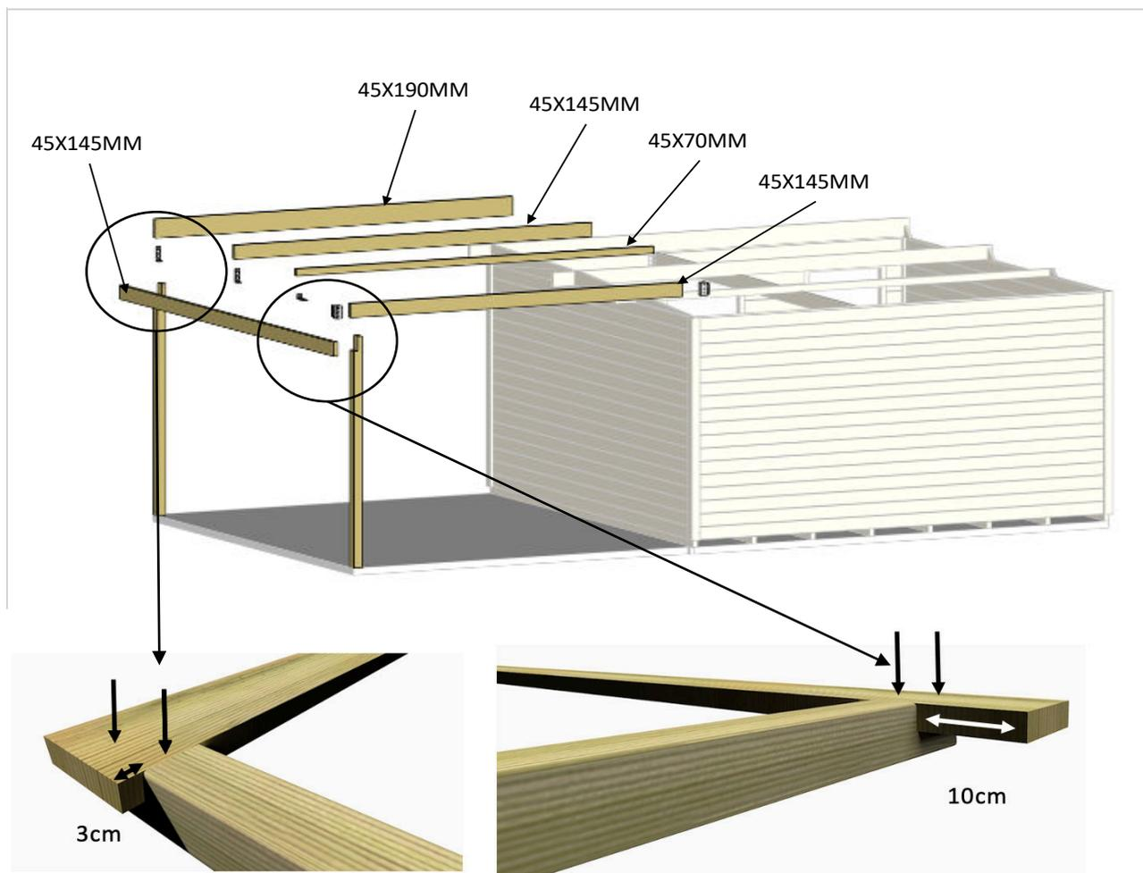
Positionnez la panne dans l'encoche des poteaux, laissez sortir au niveau de la façade 3 cm par rapport au poteau et sur le fond 10 cm. Puis vissez celle-ci aux poteaux (5x70mm)
