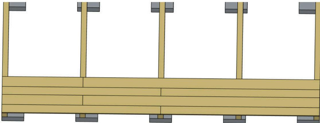
Pour une pose parquet, la jonction entre les planchettes sur une longueur doit se faire au niveau des lambourdes. Les jonctions ne doivent jamais être sur la même lambourde.
