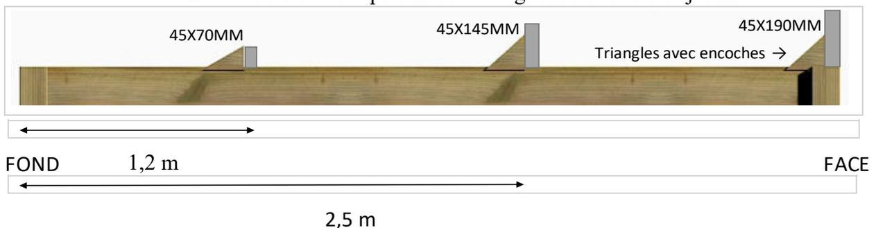
Découpez les pannes à la longueur nécessaire, elles doivent dépasser de 3 cm par rapport au mur et donc arriver au niveau des poteaux.
