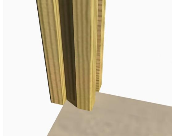
Positionnez les quatre poteaux aux extrémités de la dalle de cette façon. Veillez à ce que les poteaux restent bien de niveaux au fur et à mesure que vous glissez les planches.
