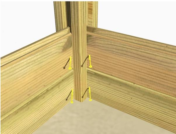
Afin de maintenir les poteaux droit, commencez à emboîter les planches dans les rainures des poteaux sur les murs qui n'ont pas d'options (Portes, Fenetre) et vissez-les (5x70mm) de cette façon. Vous devez visser les planches par l'intérieur.
