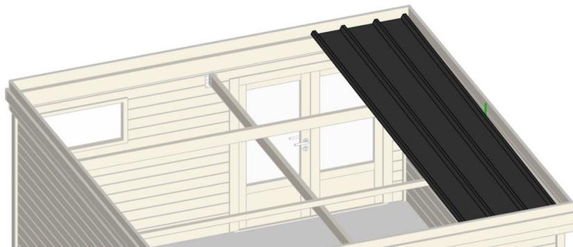
Vissez-les à l'aide des vis de tôle sous chaque panne est sur chaque ondulation de la tôle. Il faudra aussi visser dans le mur du fond. Les vis sont auto-perforante, vous pouvez donc visser directement dans le bac acier sans percer.
