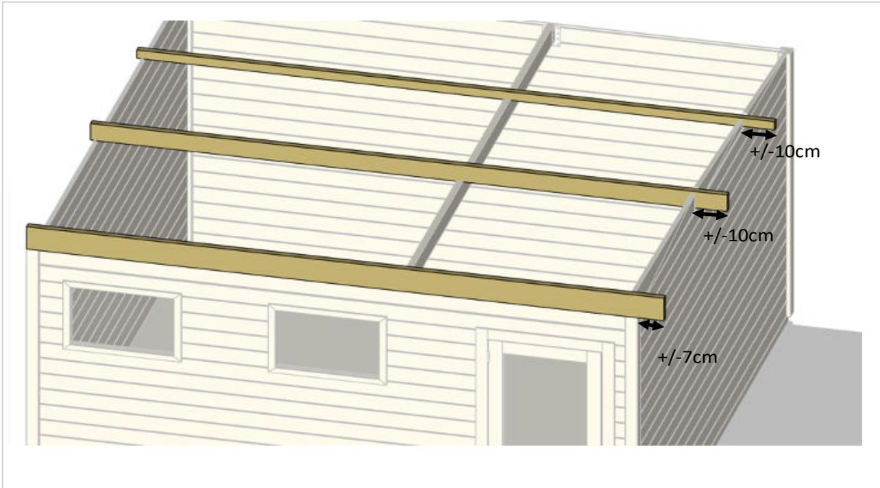
L'excédent des pannes doit dépasser du côté de l'extension de toiture. Les pannes de l'extension de toiture viennent se superposer l'une en face de l'autre avec celle de l'abri de jardin
