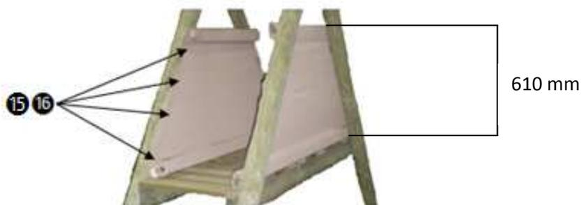
La distance entre le plancher de la plateforme et le haut de la pièce ⑤ doit être égale à **610 mm**
