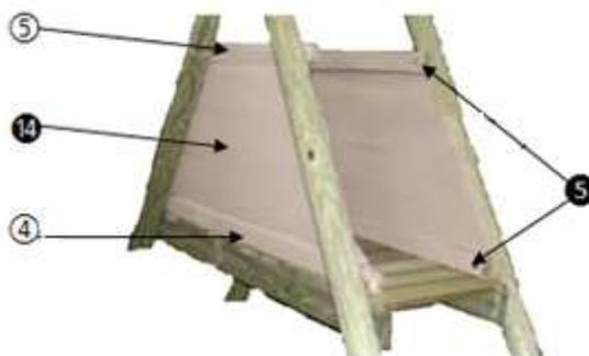
Tendez la toile en la vissant directement contre les pieds (pièces n°2) à l'aide des vis 4x35 mm (⑮) – 8 vis pour une toile. Mettre préalablement une rondelle Ø 4 mm (⑯) sur ces vis.
