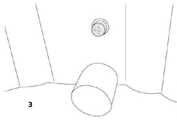
Mettez le couvercle de la cartouche de filtre et placez la cartouche de filtre à l'entrée d'eau en la tournant dans le sens des aiguilles d'une montre.
