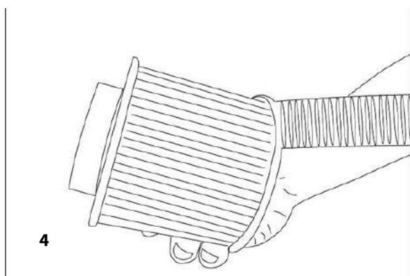
La cartouche de filtre peut être rincée avec un tuyau d'arrosage et réutilisée. Cependant, si la cartouche de filtre reste sale et décolorée, elle doit être remplacée.
