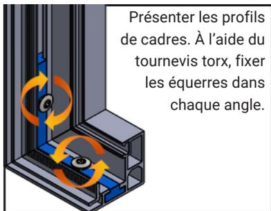
Présenter les profils de cadres. À l'aide du tournevis torx, fixer les équerres dans chaque angle.
