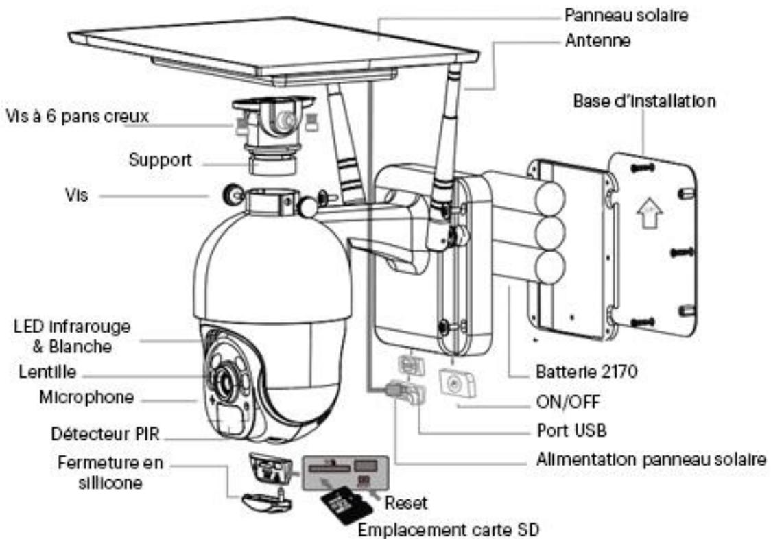
Avant toute installation, veuillez insérer le câble USB du panneau solaire dans la Fermeture en silicone afin de charger la batterie de la caméra.
