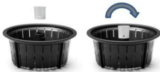
Le bouchon N°14 pour retirer le petit panier de cuisson du bol inox après cuisson (lorsqu'il est encore trop chaud), se tourne d'un huitième de tour, il est maintenu par un système à baïonnettes
