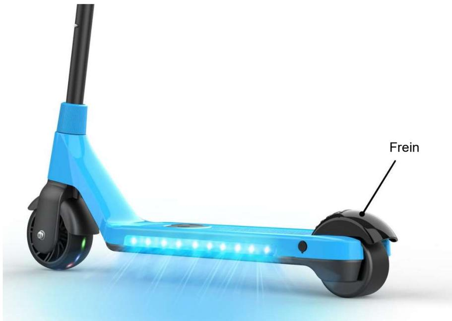
6. Pour s'arrêter. Utilisez un pied pour appuyer sur le frein mécanique arrière. Après le bip, continuez d'appuyer sur le frein jusqu'à ce que la trottinette électrique pour enfants s'arrête.
