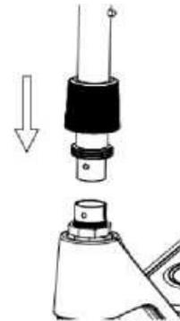
2. Connectez le tuyau vertical à la plaque du bas et alignez-le avec la vis
