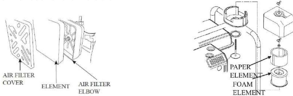
Dévissez l'écrou papillon et retirez le logement du filtre à air. Si l'élément est encrassé, nettoyez-le; s'il est endommagé, remplacez-le par un neuf. Réinstallez le filtre à air dans l'ordre inverse et vissez l'écrou papillon..
