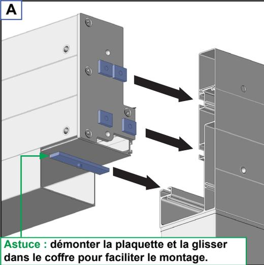
**Astuce :** démonter la plaquette et la glisser dans le coffre pour faciliter le montage.
