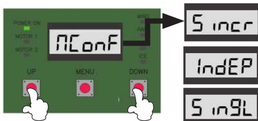
3 - A l'aide des boutons « UP » ou « DOWN », sélectionner « Sincr ».
