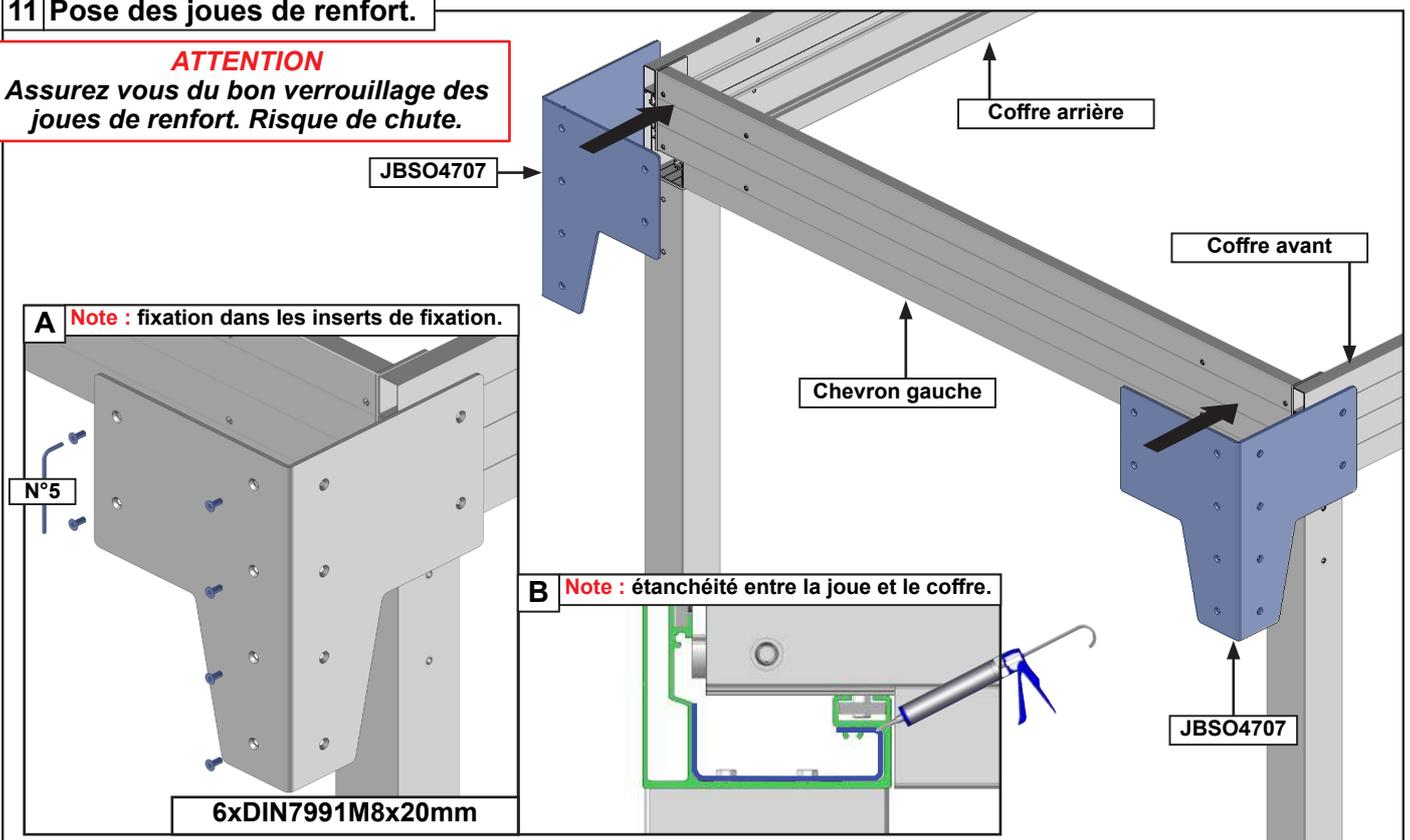
**A** **Note :** fixation dans les inserts de fixation.
