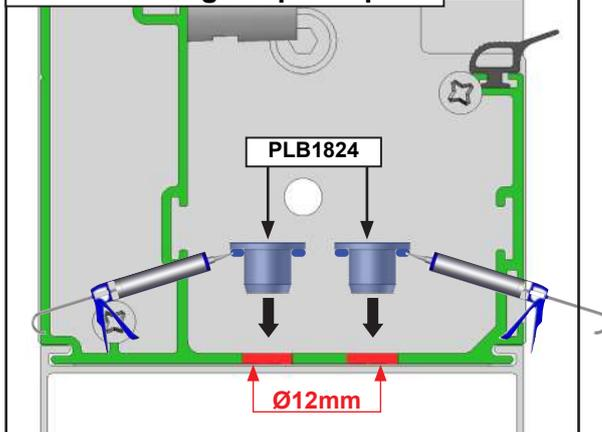
**Note :** 1 trou par rallonge. Pergola double travée, réaliser les perçages sur les chevrons support de lames mécanisés.
