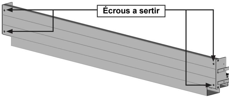
**Chevron support de lame mécanisé:**
