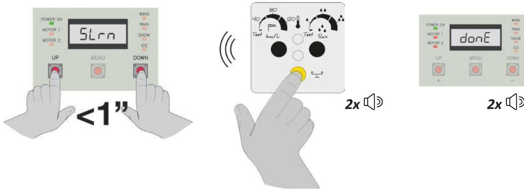
Répétez la procédure pour effacer le capteur de la mémoire. / Repeat the procedure to erase the sensor from memory.
