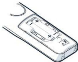
► Placer les batteries (voir l'image pour le sens d'insertion +/-).
