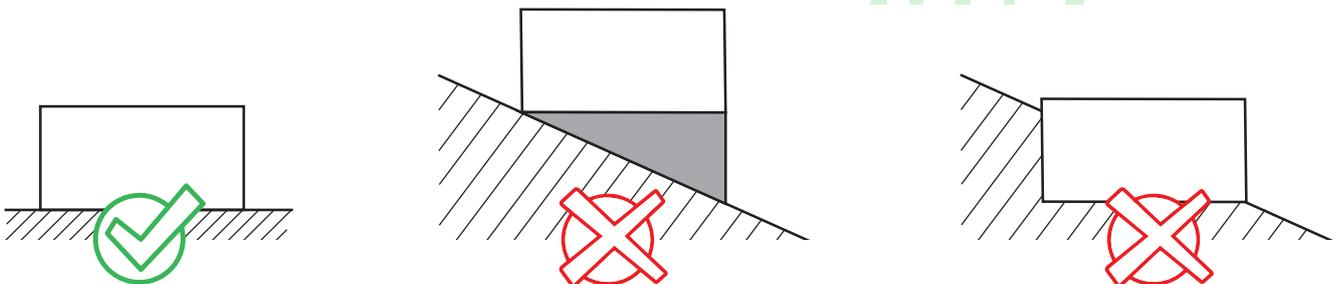
4. Les travaux de fondation doivent être réalisés conformément aux instructions contenues dans cette notice. N'oubliez pas que la préparation du sol doit être effectuée conformément aux règles de l'art de la construction. Prévoyez également le temps nécessaire au séchage et à la prise du béton. La classe du béton ne doit pas être inférieure à C25/30, la classe d'exposition XC2.
