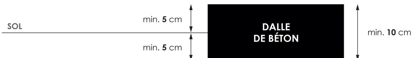
6. Les supports métalliques doivent être bétonnés conformément aux instructions indiquées dans la notice.
