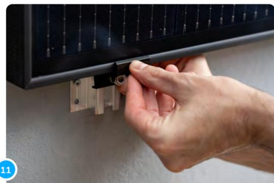
11 Les pinces s'enfoncent dans le rail par devant ou par le dessus. En appuyant vers le bas, le ressort pivote à 90° et s'enclenche.
