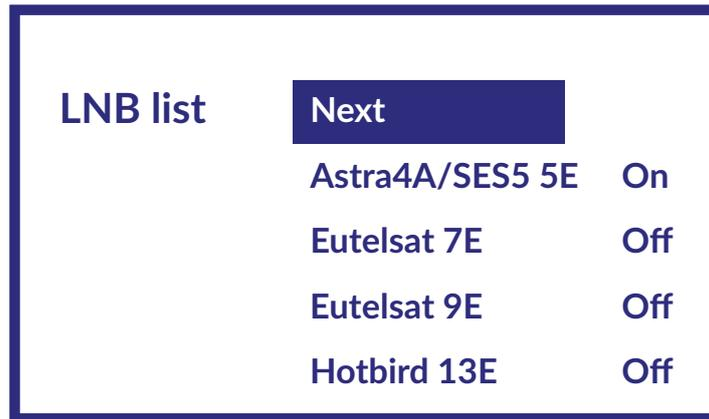
Utilice las teclas ▲▼ para seleccionar el satélite (o los satélites) al que se dirige su antena. Pulse **OK** para acceder al submenú que permite activar o desactivar el satélite seleccionado y configurar sus distintos parámetros. Una vez realizados todos los ajustes, seleccione **SIGUIENTE** para continuar.
