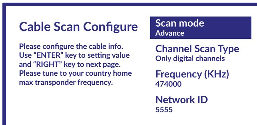
En el menú *Modo escaneo* puede elegir realizar un escaneo completo seleccionando *Completo*, mientras que seleccionando *Avanzado* puede realizar un escaneo utilizando los datos de Frecuencia e ID de red proporcionados por su operador. Utilice el botón **OK** para configurar el valor y ► para iniciar la búsqueda de canales.
