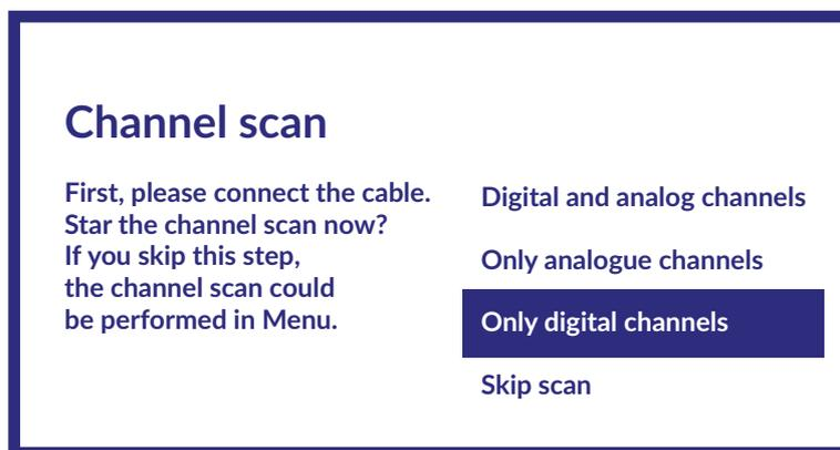
El primer paso consiste en conectar el cable. A continuación, debe iniciar la búsqueda de canales. Puedes elegir entre *canales digitales y analógicos, solo canales analógicos o solo canales digitales*. Si omite este paso, podrá realizar la búsqueda de canales más tarde accediendo al menú TV. Pulse **OK** para confirmar la selección.
